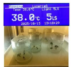
Fig.4: Vasi di coltura in vitro in trattamento termico a 38°C
